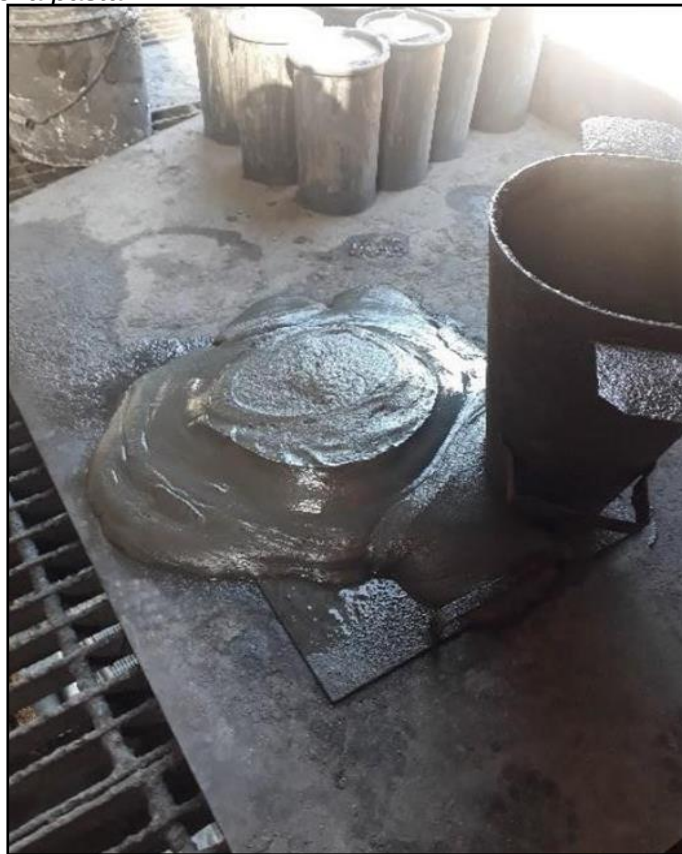
Prueba de Slump de la pasta
