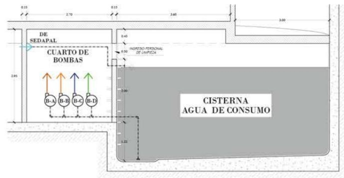
ESQUEMA DE SISTEMA DE BOMBEO DE AGUA POTABLE CORTE A-A'
