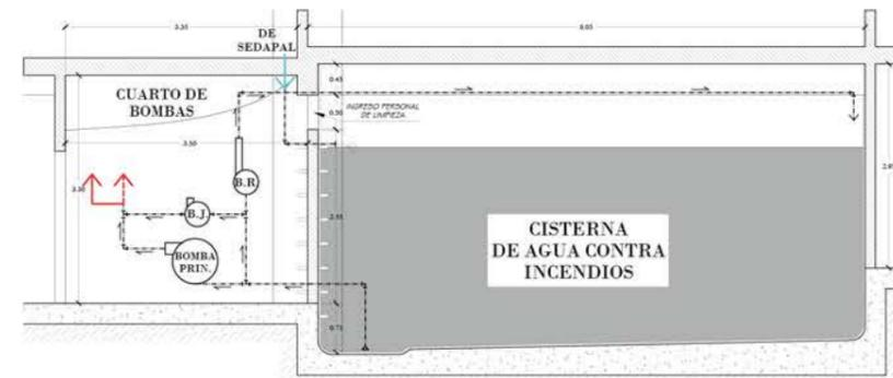
ESQUEMA DE SISTEMA DE BOMBEO DE AGUA CONTRA INCENDIOS CORTE B-B'
