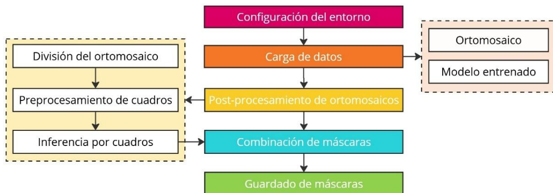
Figura 53: Diagrama del procedimiento estándar para la segmentación de grietas en el ortomosaico.
