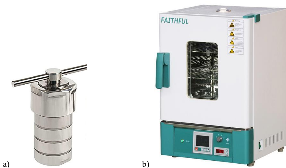
Figura 17. a) reactor para síntesis hidrotermal b) estufa digital para laboratorio de 45 litros
