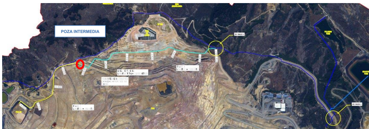
Alternativa 1 sistema de bombeo con poza intermedia
