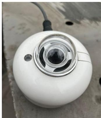
Figura XXX. Piranómetro utilizado para optimizar el trazador de curva I-V.
