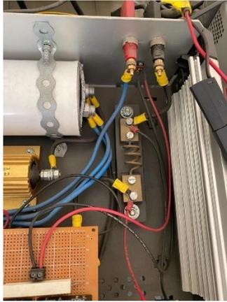
Figura XIX. Resistencia shunt 60 mV 10 A.
