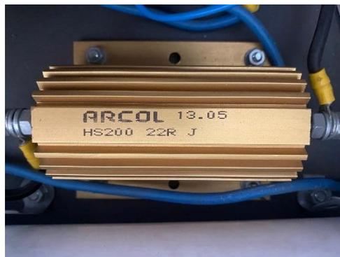
Figura XXV. Resistencia de descarga para disipar la energía almacenada en el capacitor luego de la medida.
