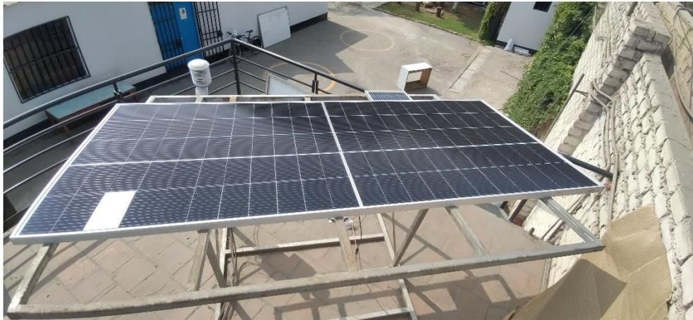
Figura XXXIX. Módulo FV Trina Solar siendo evaluado con el trazador optimizado. El parche blanco muestra que se está haciendo la prueba de puntos calientes al módulo.
