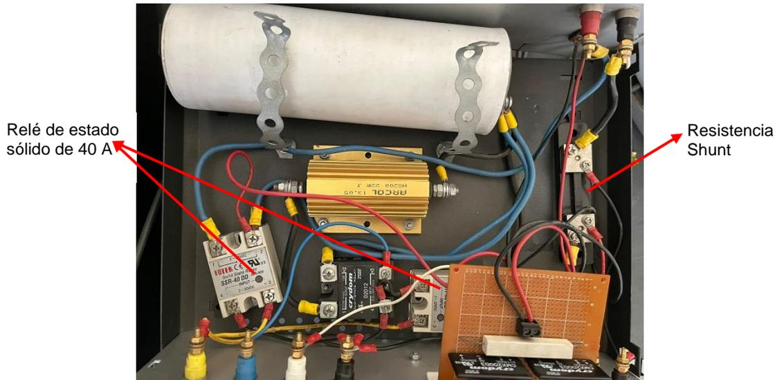
Figura XXIX. Relés cambiados, circuito de potencia con los cambios realizados.
