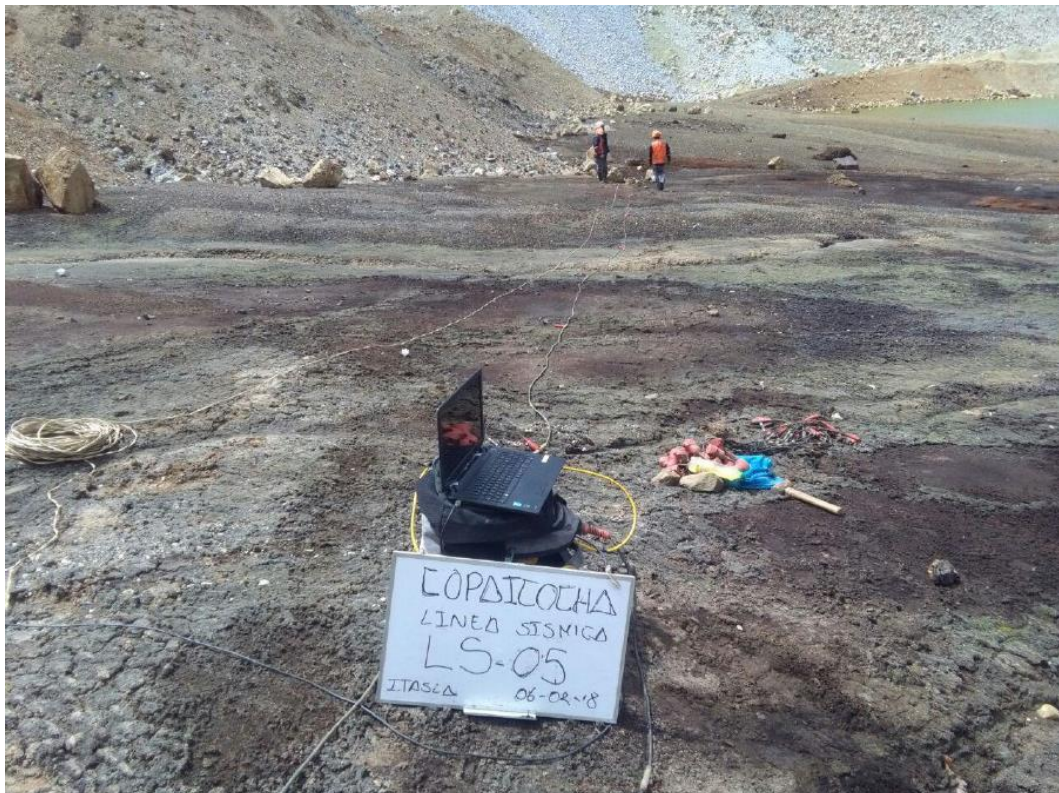
Foto N°17: Línea Sísmica – MAM-02
