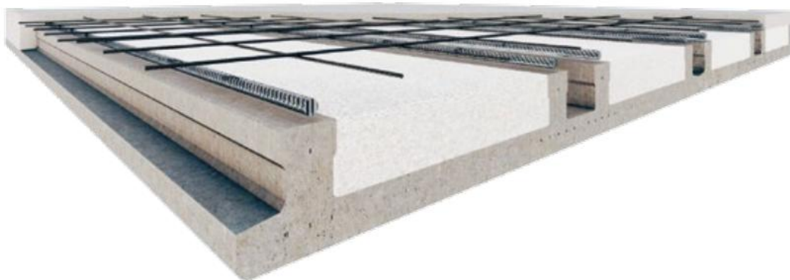
Ilustración 69. Sección de losa usando prelosa
