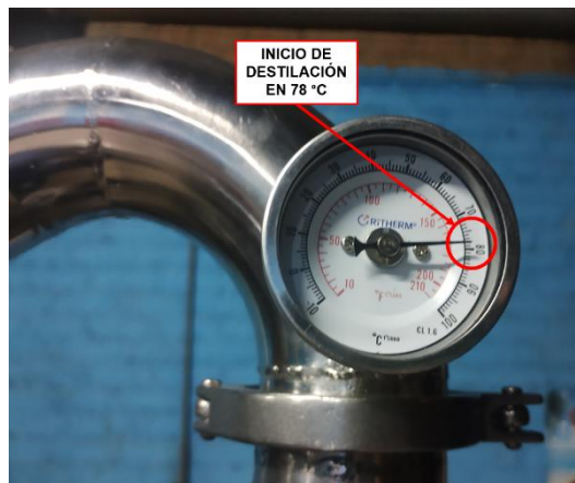
Figura 60: Pruebas de funcionamiento con materia prima de fermentado de almidón de papa producto alcohol de papa de 40°-60°, se comprueba la T de inicio en 78 °C.
