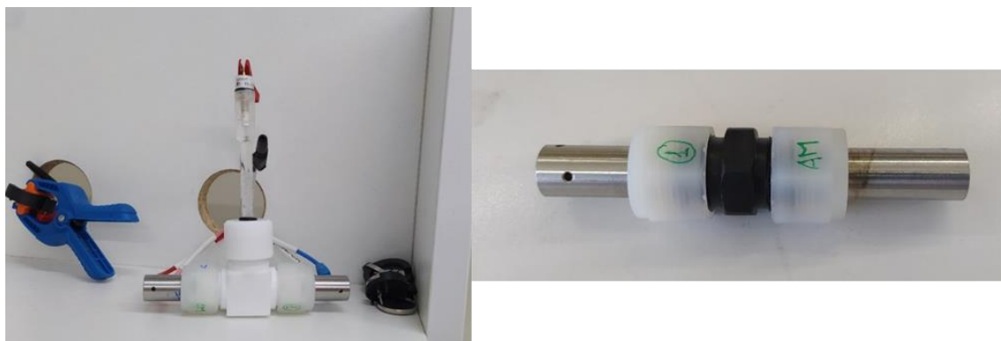
Figura 16. Montaje de las celdas tipo Swagelok con 3 electrodos (izquierda) y 2 electrodos (derecha).
