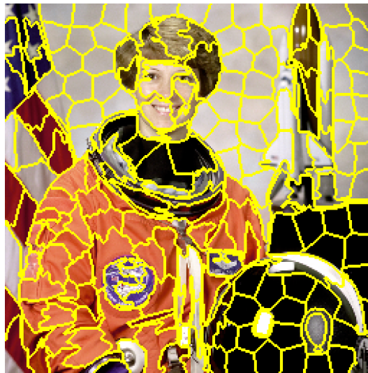
Figura V: Implementación del método SLIC en una imagen de 512x512 píxeles, generando 190 segmentos.
