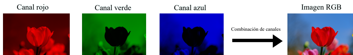
Figura II: Composición de canales de color para crear una imagen RGB.
