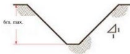
TALUD SIMPLE TIPO DE SUELO B
