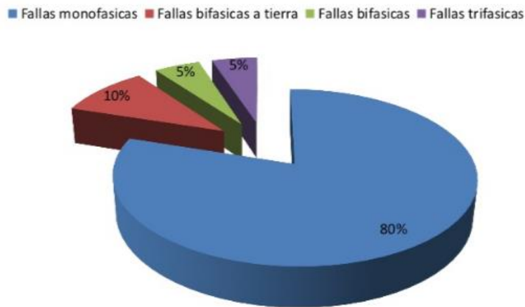
Fig.1.4: Tasa de fallas eléctricas en las redes de transmisión en los Sistemas eléctricos de Potencia (Fuente: Referencia [17])
