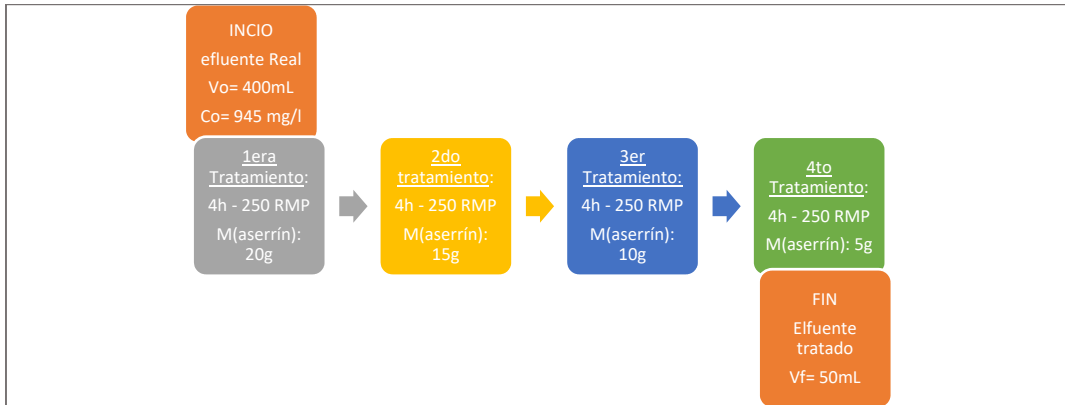
Diagrama de Tratamiento de Efluente real de curtiembre
