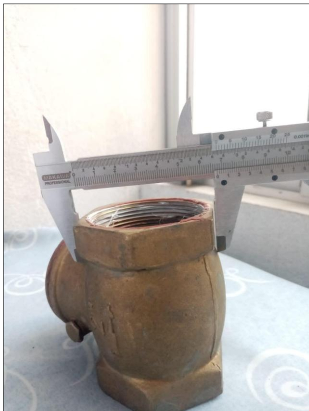
Fotografía 2: Componente del sistema de impulsión (válvula check horizontal y válvula de pie vertical)
