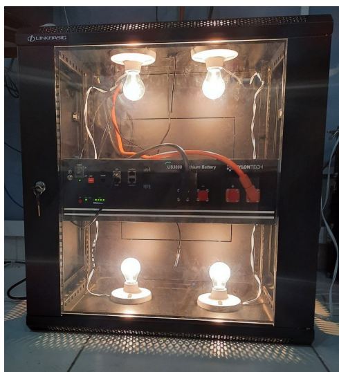
Figura 5.7: Banco de pruebas para evaluar el estado transitorio de la temperatura de la batería. (Fuente: Elaboración propia)
