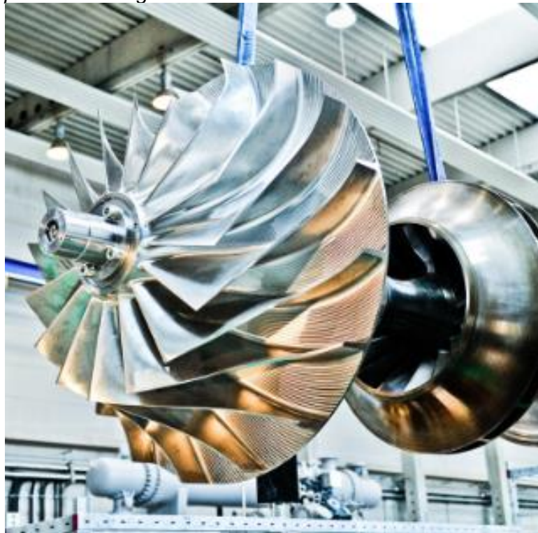
Rodete de compresor centrífugo
