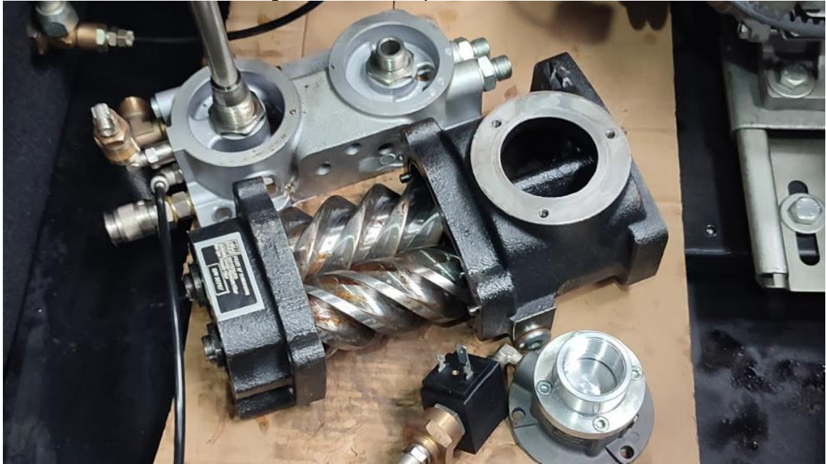
Tornillos helicoidales con desgaste de un compresor
