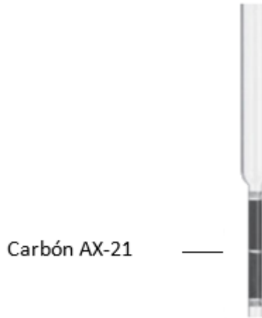
Figura 7 Columna de carbón activado AX-21
