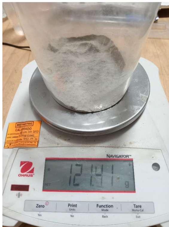
Anexo 4. Pesado de aditivo 1 empleado en mezcla A1-M2
