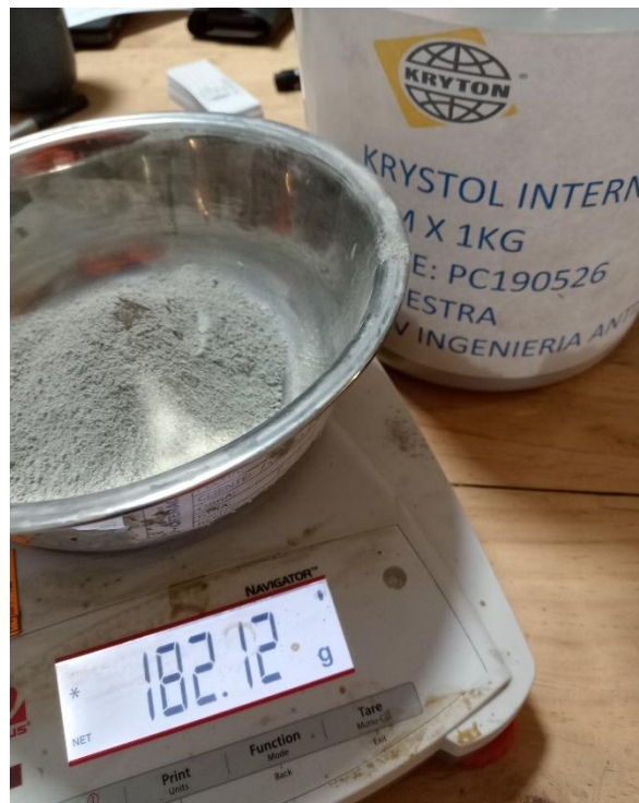
Anexo 12. Pesado de aditivo 2 empleado en mezcla A2-M3
