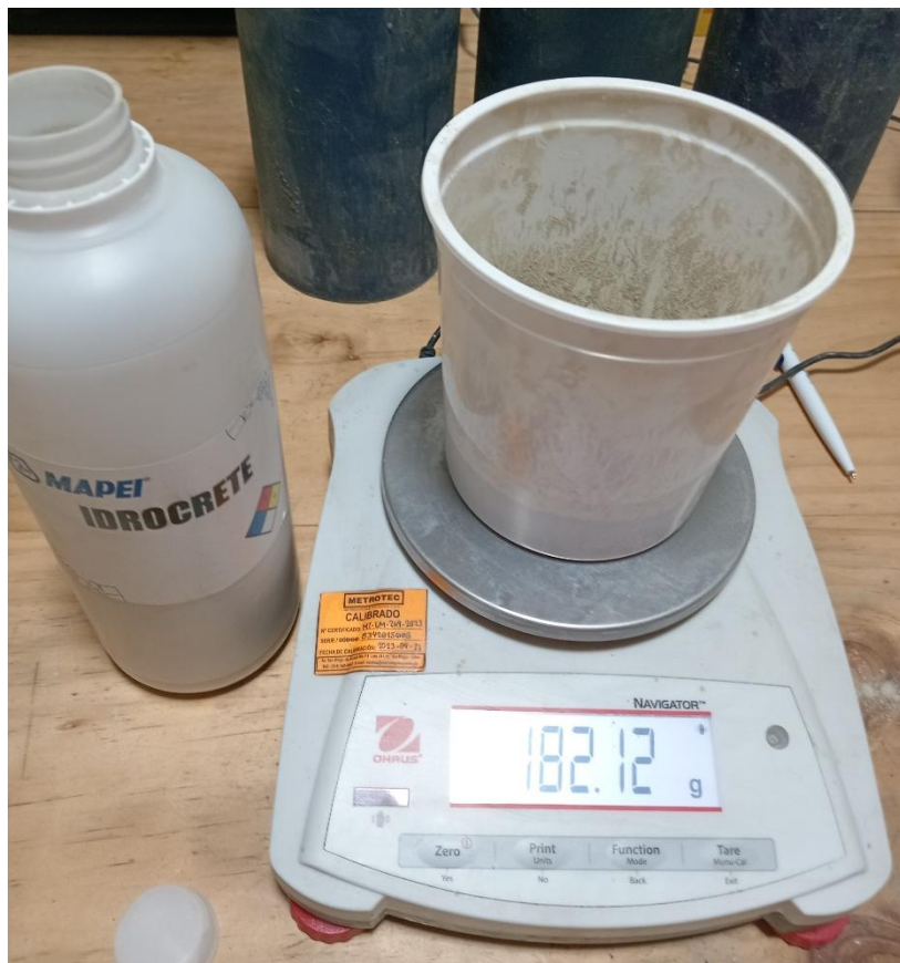
Anexo 20. Pesado de aditivo 3 empleado en mezcla A3-M3
