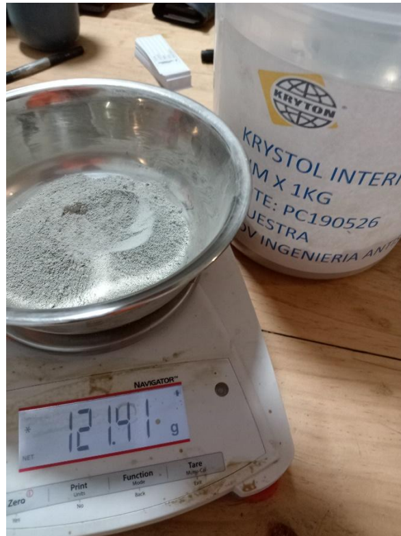
Anexo 11. Pesado de aditivo 2 empleado en mezcla A2-M2
