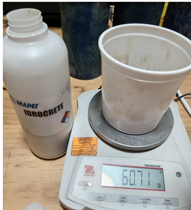
Anexo 16. Pesado de aditivo 3 empleado en mezcla A3-M1
