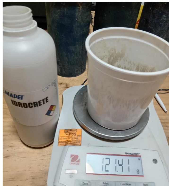
Anexo 18. Pesado de aditivo 3 empleado en mezcla A3-M2
