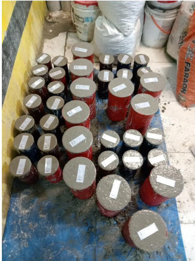
Anexo 23. Vaciado de concreto en probetas y etiquetado
