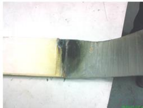
Bobina en falla
