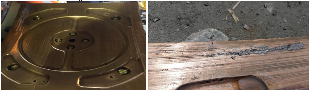
Figura 4: Falla de PADs por ingreso de material extraño.
