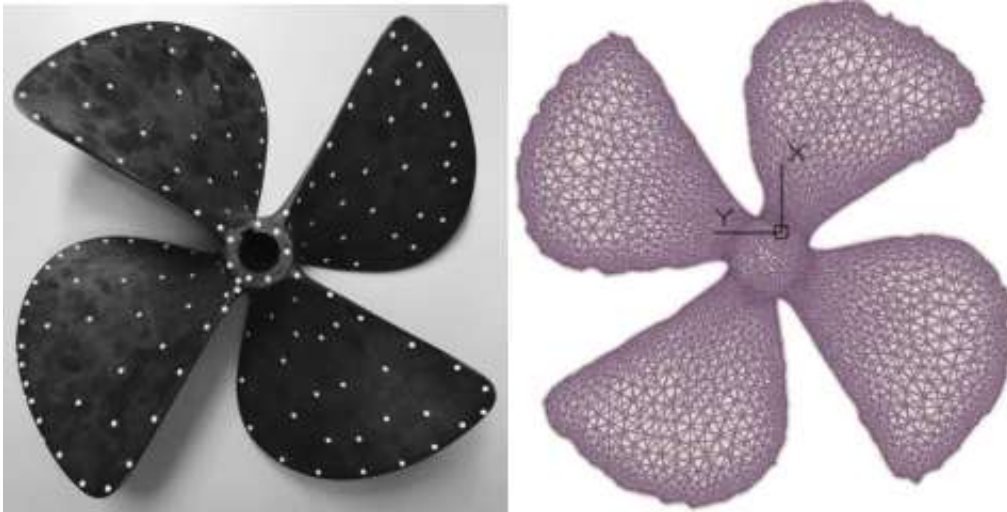
Figura 4.6 Levantamiento de la geometría de la hélice
