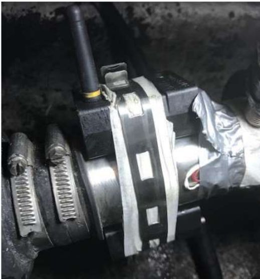
Figura 4.3 Instalación de strain gage y sistema de telemetría
