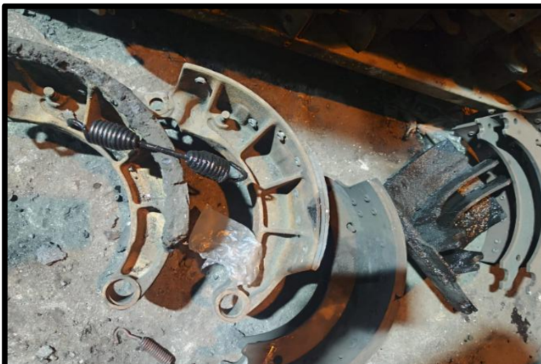
Figura 16: Unidad 565 parada por falta de zapatas en sobremedida y accesorios
