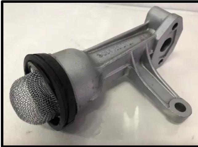
Figura 21: Evidencia del colector de aceite en su correcta instalación
