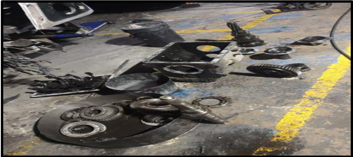
Figura 15: Unidad 608 parada por falta de repuestos para caja de cambio
