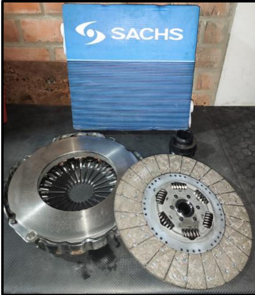
Figura 37: Kit de embrague marca Sachs
