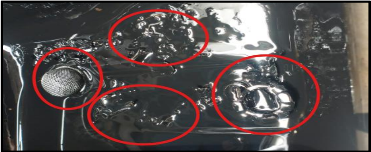
Figura 19: Evidencia del desprendimiento del tamiz bomba de aceite
