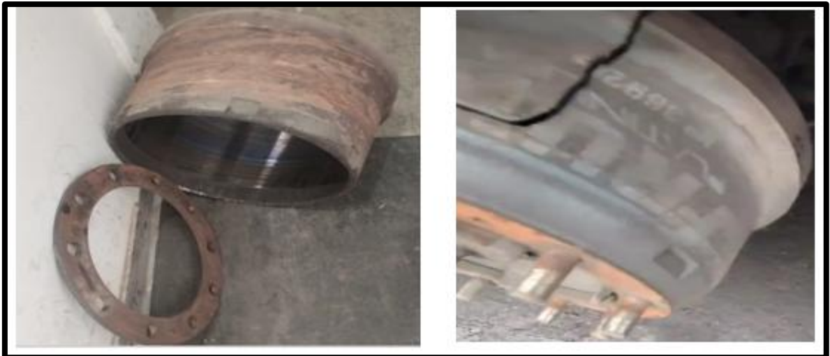
Figura 29: Tambores de frenos reventados
