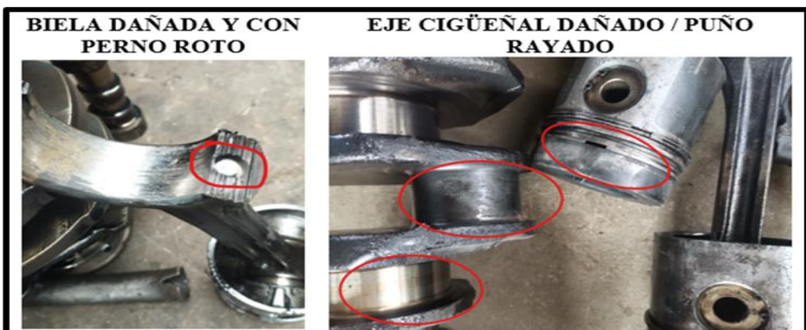
Figura 22: Evidencia piezas dañadas
