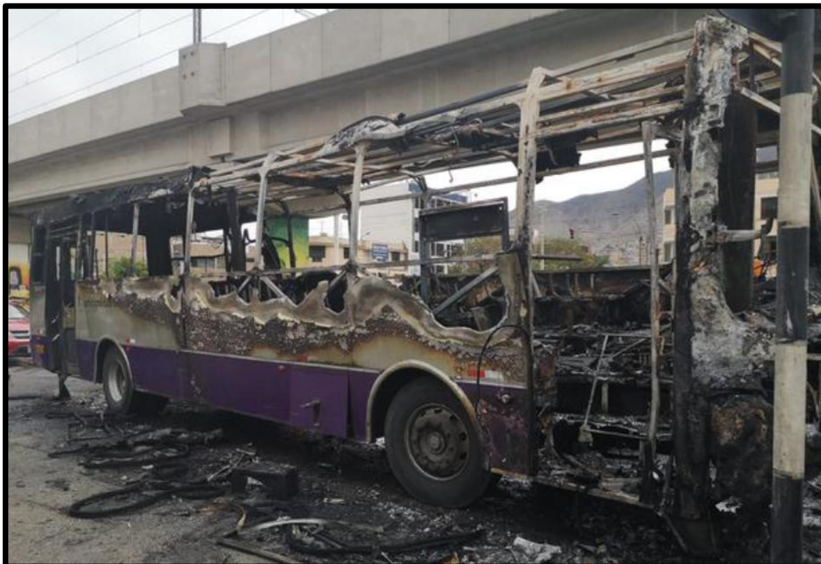
Figura 12: Unidad siniestrada por cortocircuito
