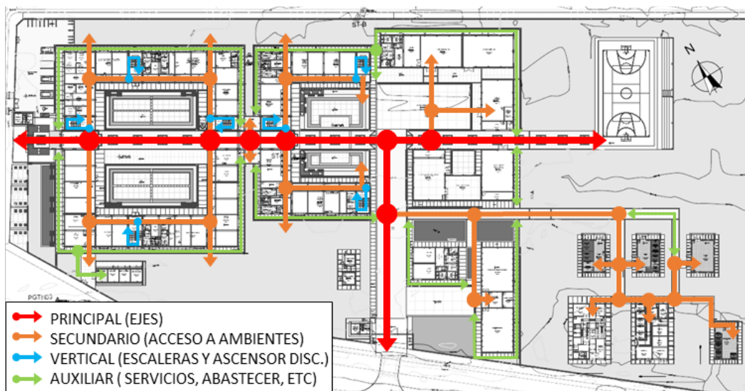
Figura 170. IESTP HUANCANÉ – Sistema de circulaciones
