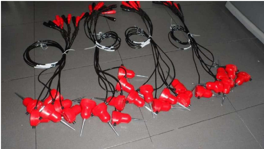
Figura 07. Geofonos de 4.5 hertz utilizados en el estudio
