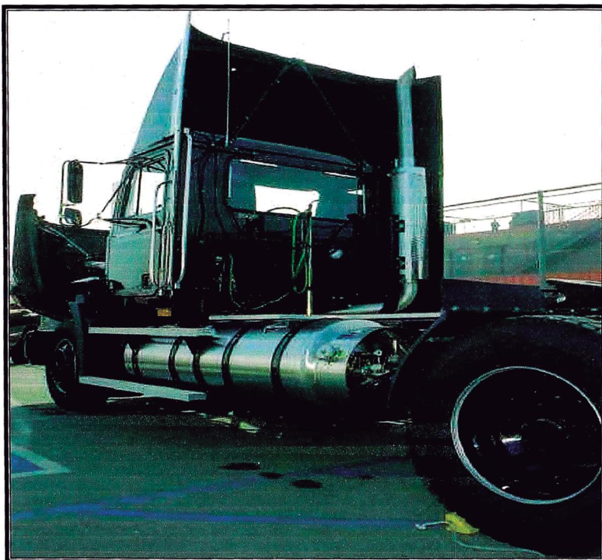
El GNL se abastece directamente a los vehículos a través de un surtidor. El combustible se almacena a bordo en un tanque criogénico.
