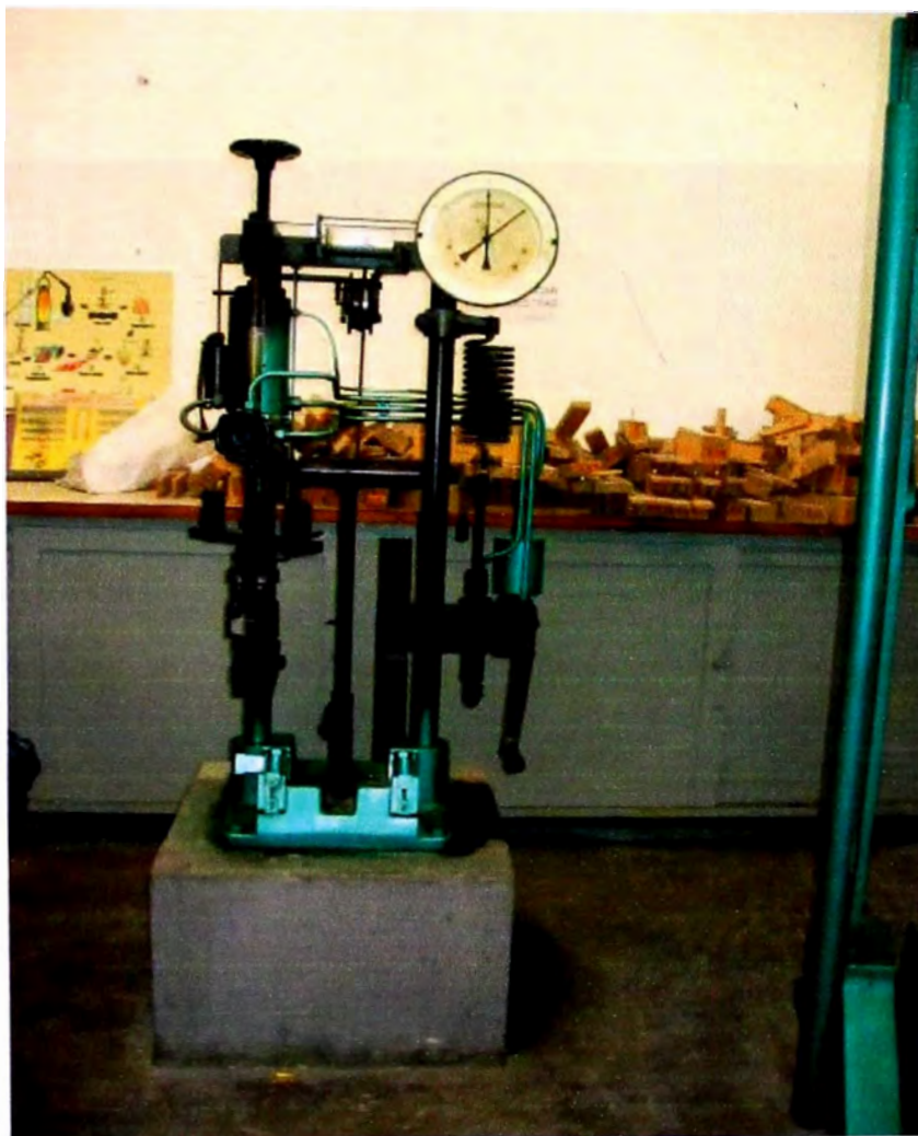
MAQUINA PARA ENSAYO DE CLIVAJE
