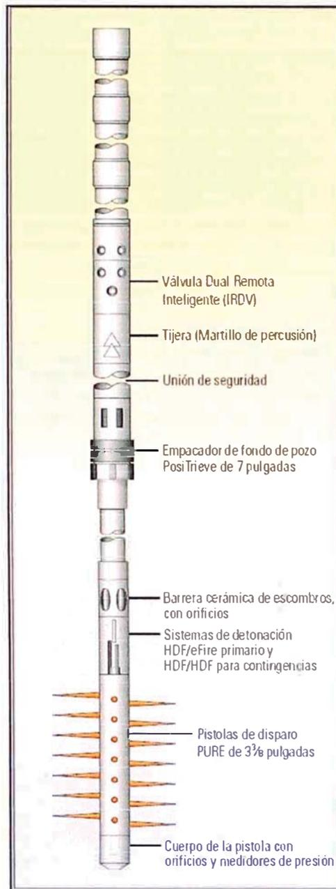
En comparación con las operaciones de baleo convencionales, los diseños con bajo balance dinámico incrementan la productividad e inyectividad del pozo y mejoran la eficiencia operacional. Los operadores han aplicado los diseños y técnicas de las operaciones de baleo con bajo balance dinámico para terminar o re-terminar en casi todos los países del mundo ahora aplicados desde el año pasado en Venezuela y Ecuador a principios de este año con éxitos rotundos. Más adelante en este trabajo
