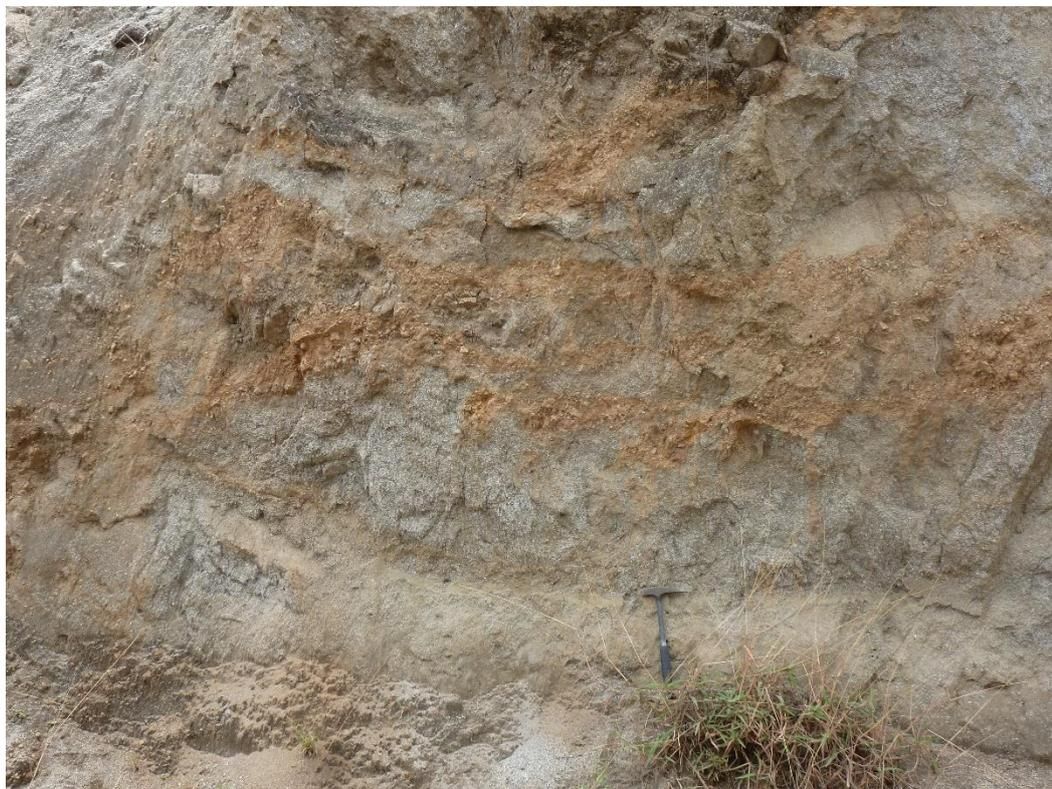
Foto 2, 8 Vista al NE de granodiorita porfírica de grano grueso oxidada (goetita y jarosita diseminada) por alteración supérgena.
