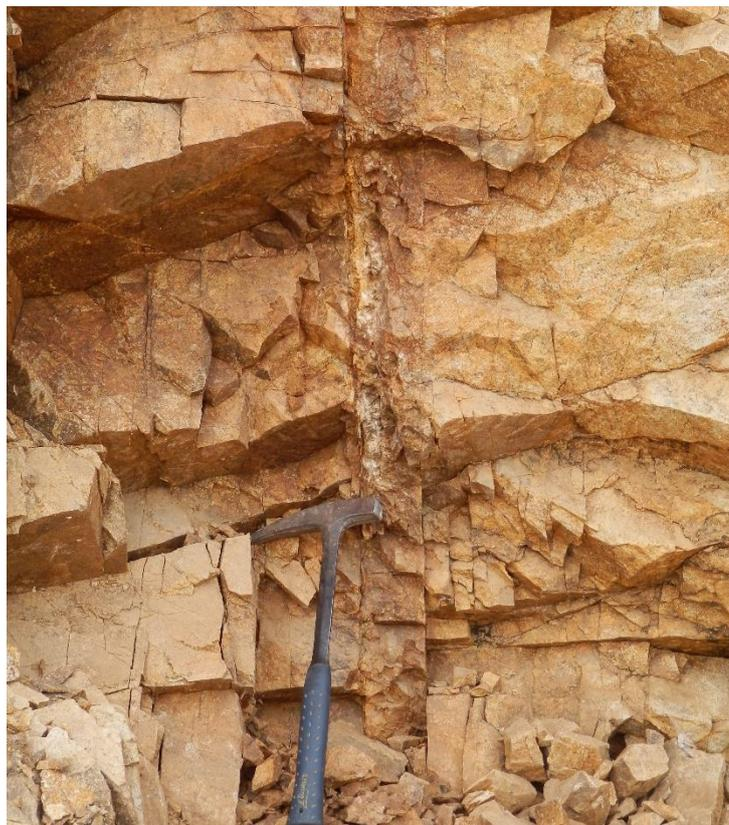
Foto 2, 12 Vetilla de cuarzo-óxidos con halo de alteración de 15 cm. cortando Intrusivo Miramar. Reporta anomalías en Ag, Pb, Zn, As, y Sb. Hacienda Miramar.
