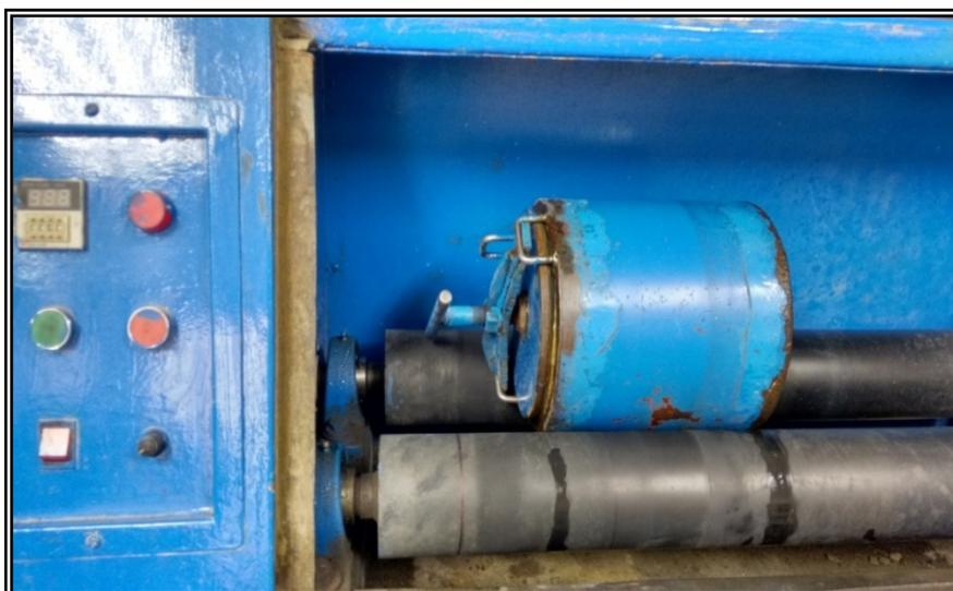
**Figura 3.3** Molino de Bolas de Laboratorio 9" x 9"
