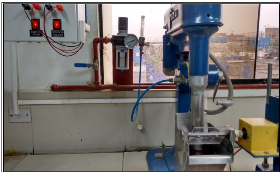
**Figura 3.4** Celda de flotación automática experimental, controles de paletado y pesas para el control del nivel de pulpa, manómetro y flujómetro de aire, celda de flotación y dispositivo mecánico de paleta
