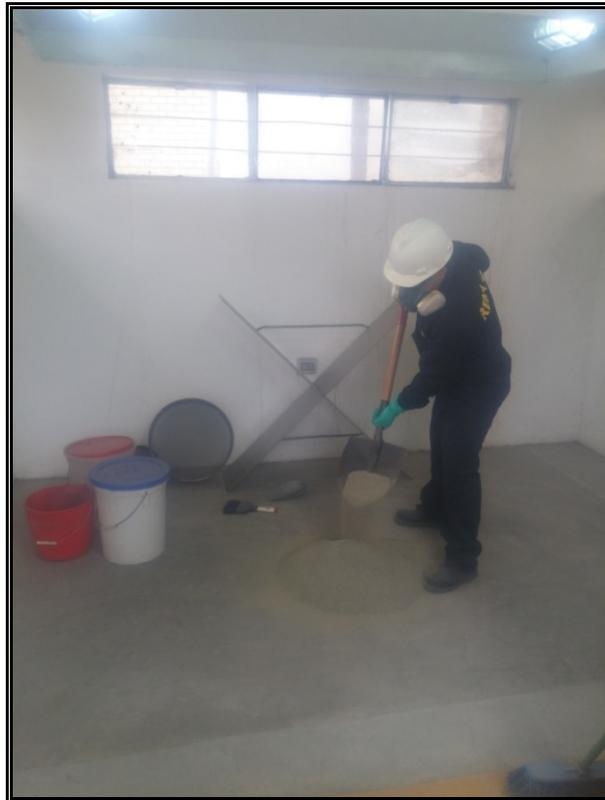
**Figura 3.2** Homogenización y cuarteo
