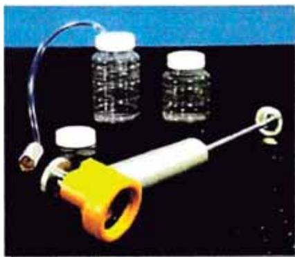
**Figura N° 45.- Instrumento de Extracción de Muestra (Mariposa)**
