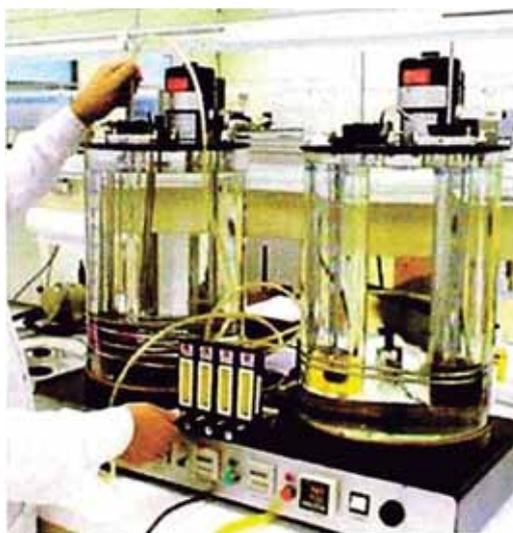
**Figura N°26.- Equipo de Análisis de Viscosidad a 40°C y 100°C**
