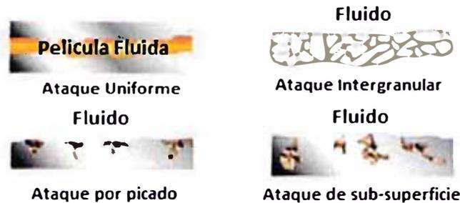
**Figura N°30.- Desgaste Corrosivo**
