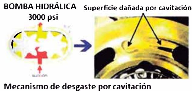
**Figura N°32.- Desgaste por Cavitación**
