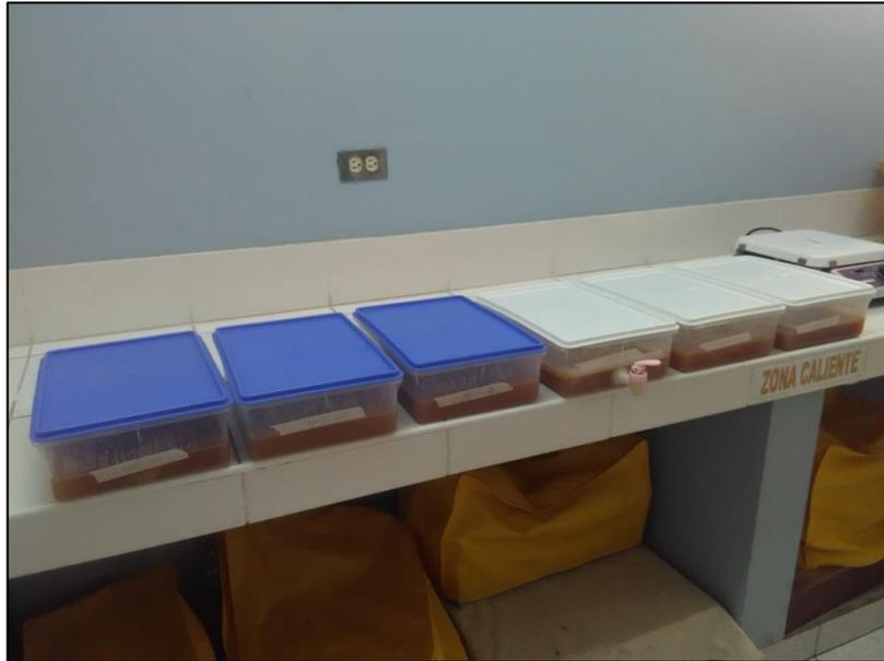
**Figura 5.25 Fermentadores acéticos.** Nota: Fotografía tomada en el Lab. 11 de la FIQT.
