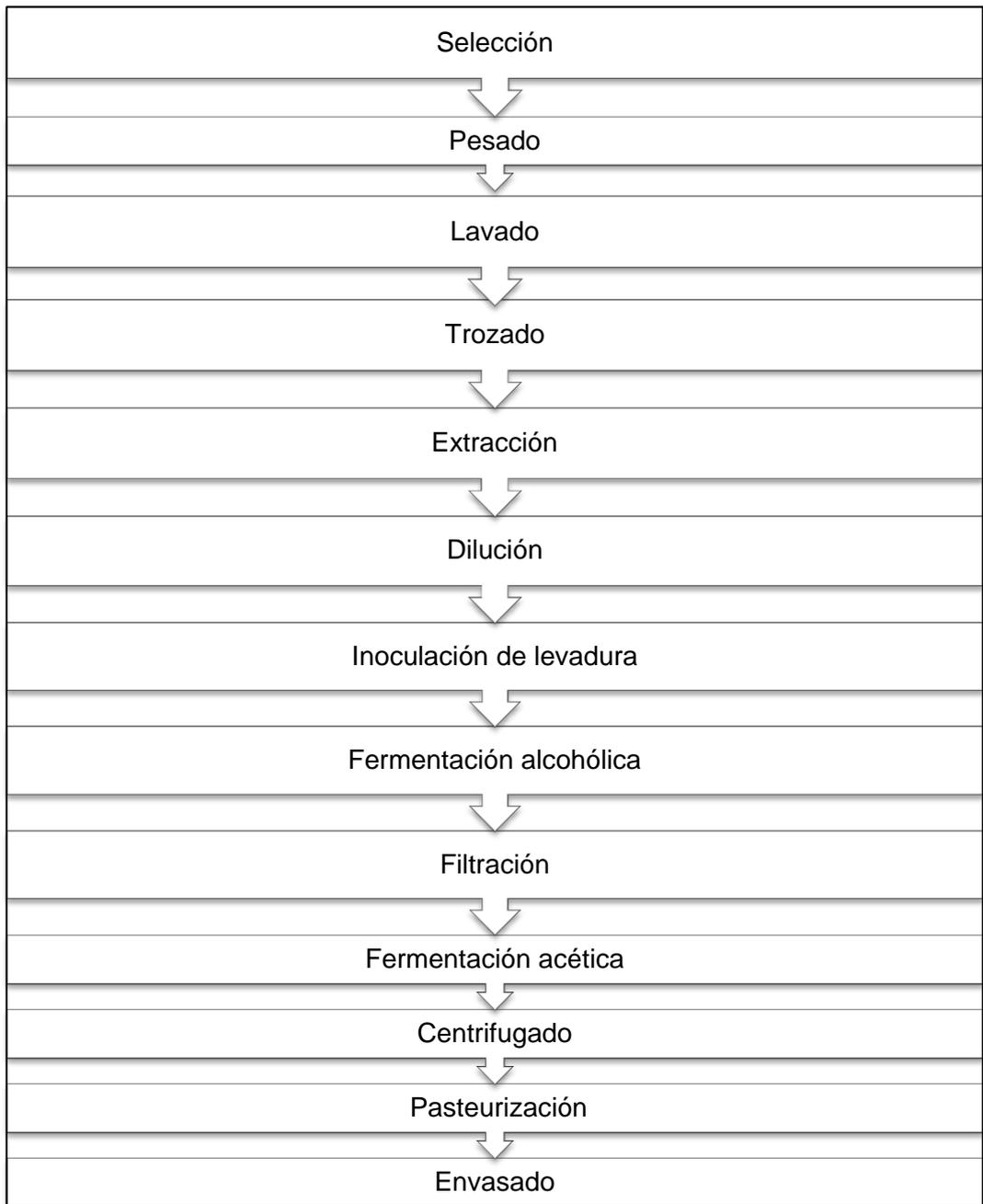
**Figura 5.13 Diagrama de bloques del proceso óptimo.** Fuente: Hatta
