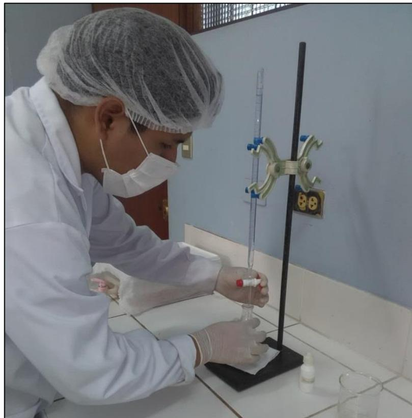
**Figura 5.26 Titulación ácido-base.** Nota: Fotografía tomada en el Lab. 11 de la FIQT.
