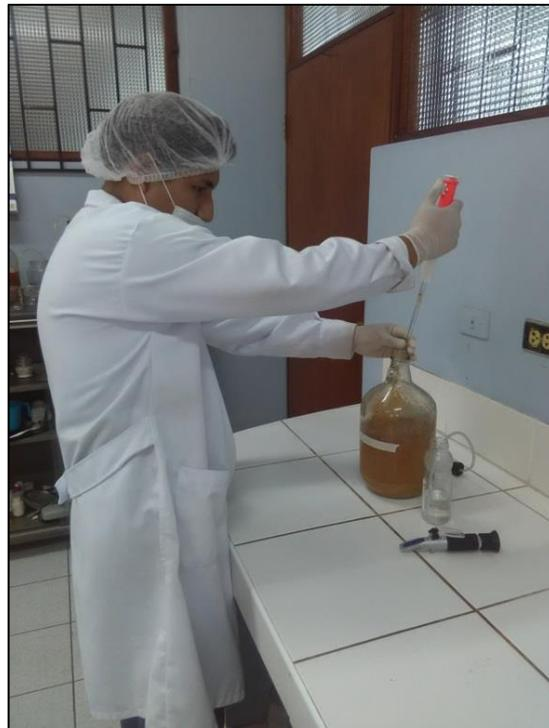
**Figura 5.22 Toma de muestras de mosto.** Nota: Fotografía tomada en el Lab. 11 de la FIQT.
