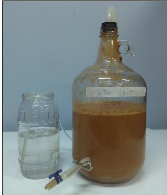
**Figura 5.21 Fermentador alcohólico.** Nota: Fotografía tomada en el Lab. 11 de la FIQT.
