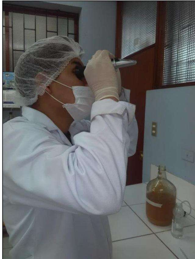
**Figura 5.23 Medición de grados Brix.** Nota: Fotografía tomada en el Lab. 11 de la FIQT.
