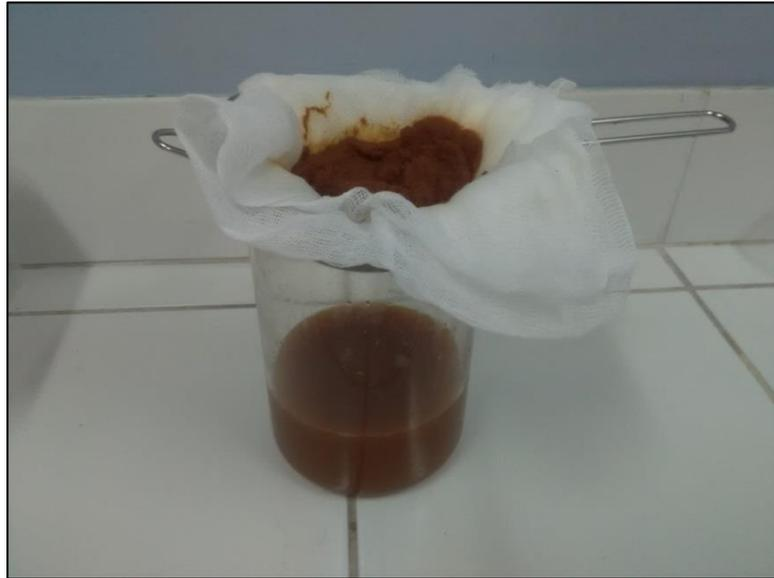
**Figura 5.24. Filtración del mosto alcohólico.** Nota: Fotografía tomada en el Lab. 11 de la FIQT.
