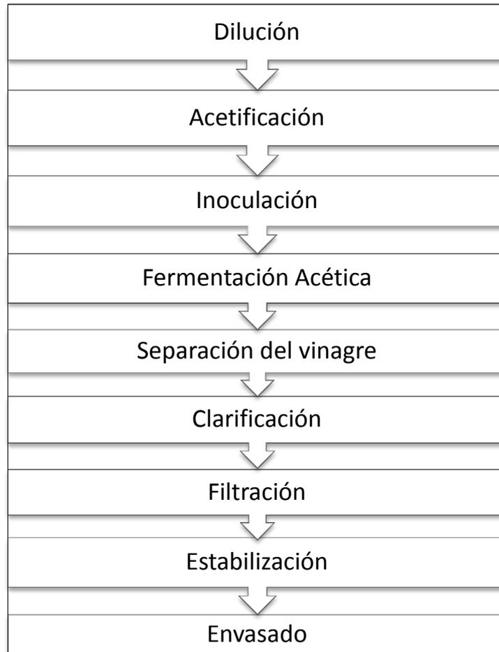
**Figura 3.4. Diagrama de flujo del proceso de producción del vinagre de manzana.** Fuente: Hatta (1993)
