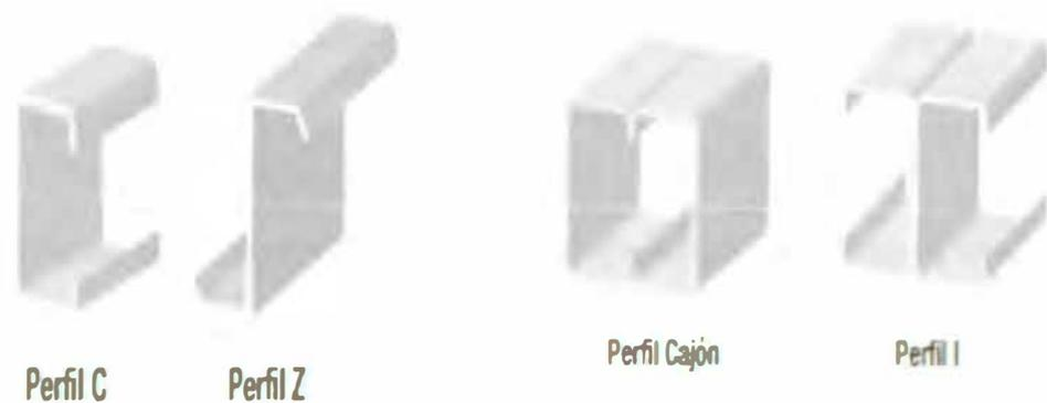
Fig. 2.11 TIPOS DE PERFILES
