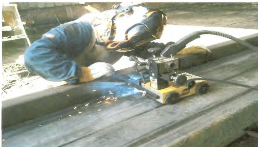
Fig. 5.10 Soldadura MIG. (Fuente: propia taller IMC)
