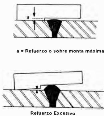
**Figura 5.3 Verificador de refuerzo de soldadura**
