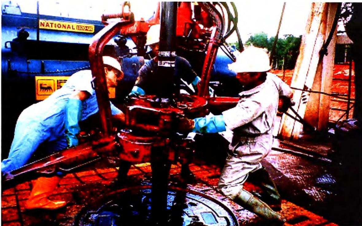
**Figura 2.2 Acoplamiento de tubos de perforación**
