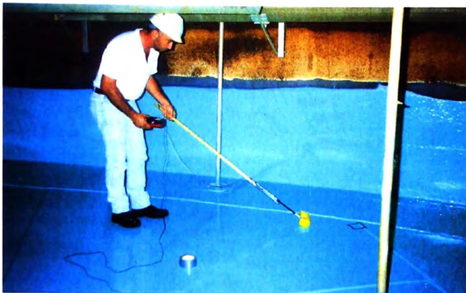
**Figura 5.26** Proceso de medición del espesor de pintura en el fondo de un tanque
