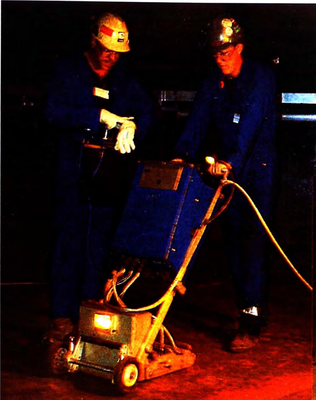
**Figura 4.12 Inspección del fondo con el método Tank Scan**
