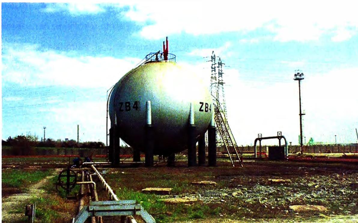
**Figura 2.8 Típico tanque esférico para el almacenamiento de Gas Licuado de Petróleo**
