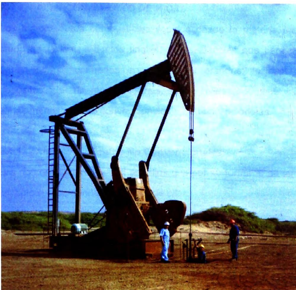
Figura 2.4 Unidad de bombeo mecánico de un pozo de petróleo
