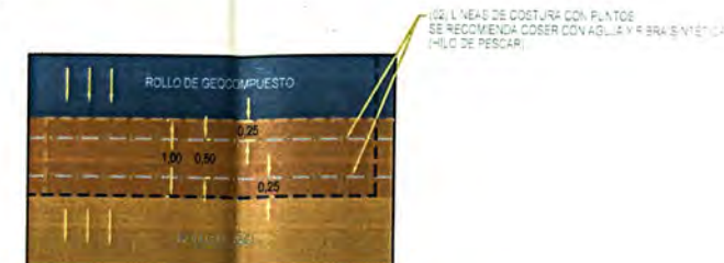
2 14 DETALLE DE COSTURA GCL - GEOCOMPUESTO
