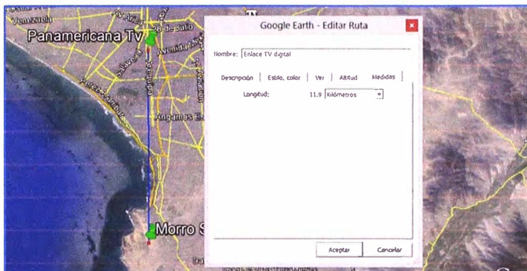
**Figura 3.19** Línea a de vista para el enlace microondas
