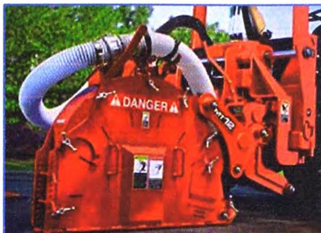
**Figura 3.13** Realización de una microzanja en una superficie de asfalto
