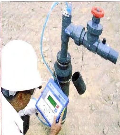
**Foto 34:** Monitoreo de biogas en pozo
