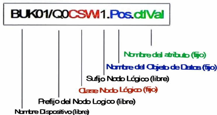
**Fig. 2.2** Estructura general de un dato en el protocolo IEC 61850 (elaboración propia basado en [5], [6]).
