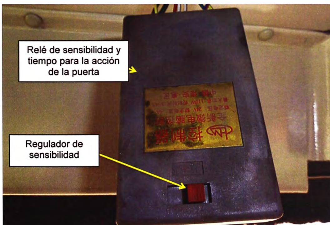
Figura 2.6 Relay de sensibilidad y tiempos de la Puerta del Bus.
