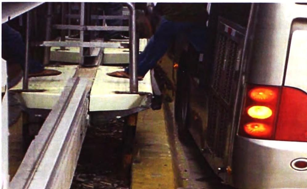
**Figura 2.11** Distancia máxima de estacionamiento 20cm.
