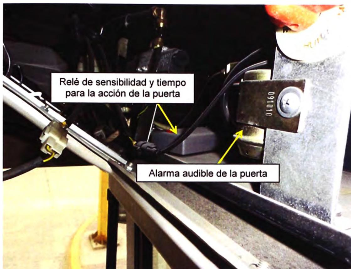
**Figura 2.9** Vista lateral del relay de Sensibilidad de accionamiento de la puerta.
