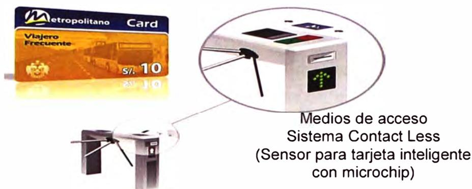
Figura 3.11 Tarjeta y lector del sistema de recaudo.
