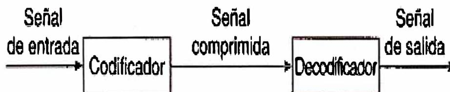
**Figura 2.9 Códec (Codificador – decodificador)**
