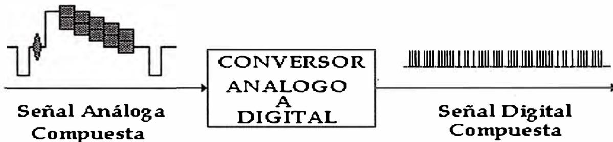
Figura. 2.25 Codificación de la señal compuesta
