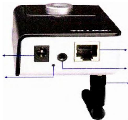
Conector de Corriente: Aquí se conecta el adaptador de corriente.
