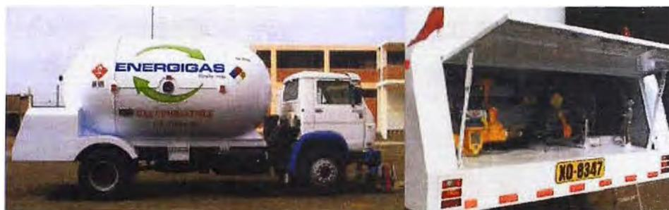
Figura N° 5.34. Distribuidor a Granel de GLP
