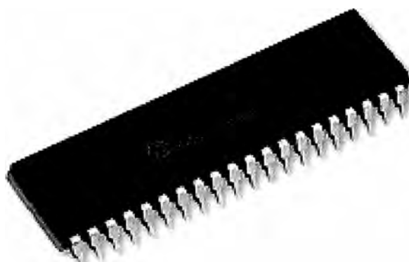
Figura A.1 Encapsulado 40 pines (Fuente: Microchip)
