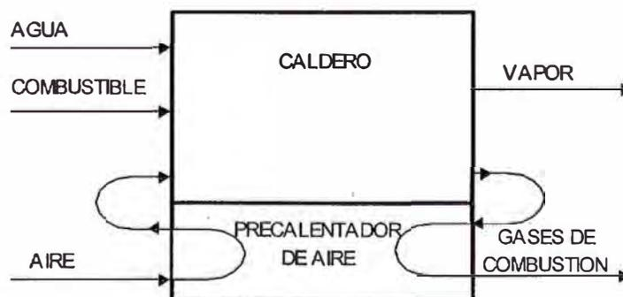
Fig. 1.2: Caldero simple más un precalentador de aire de combustión.
