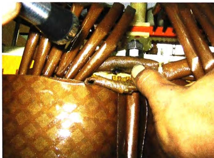
**Fig. 3.7** Descarga hacia masa debido a aislamiento deficiente.
