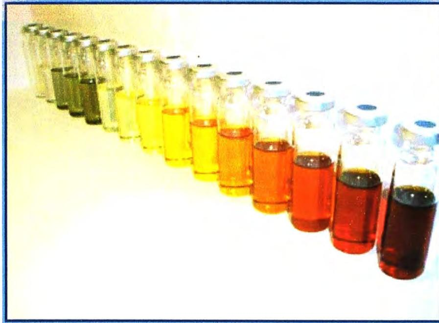
**Fig. C.1** Coloraciones de aceite de transformador
