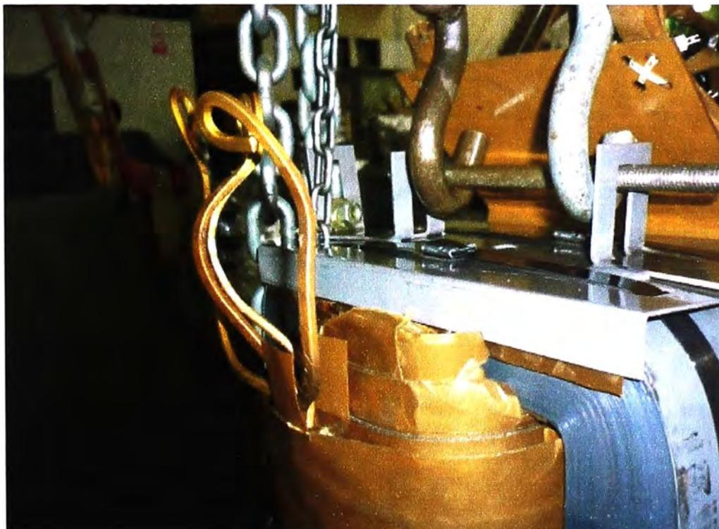
**Fig. 4.1** Traslación axial del bobinado de BT.
