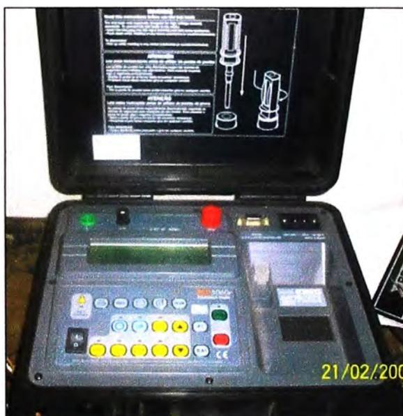
**Fig. 3.3** Megohmetro Digital para medidas de resistencia de aislamiento
