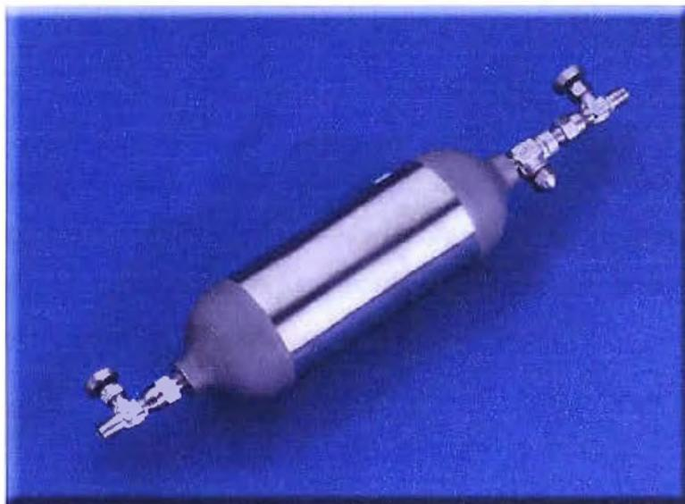
Para determinar el índice de corrosión se utiliza un bombín pequeño que cumple con las especificaciones de la norma ASTM D 1838.
