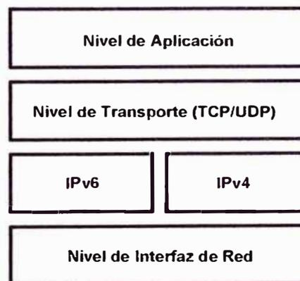
**Fig.3.1** Arquitectura de Nivel Doble IP
