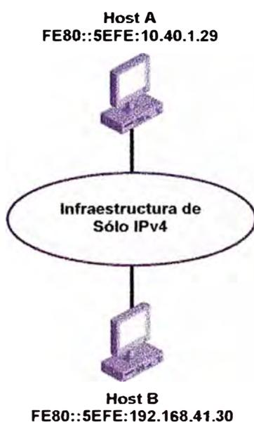
**Fig.3.10** Ejemplo de Configuración ISATAP
