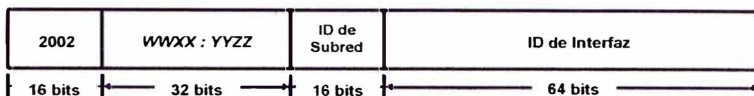
**Fig.3.14** Estructura de una Dirección 6to4
