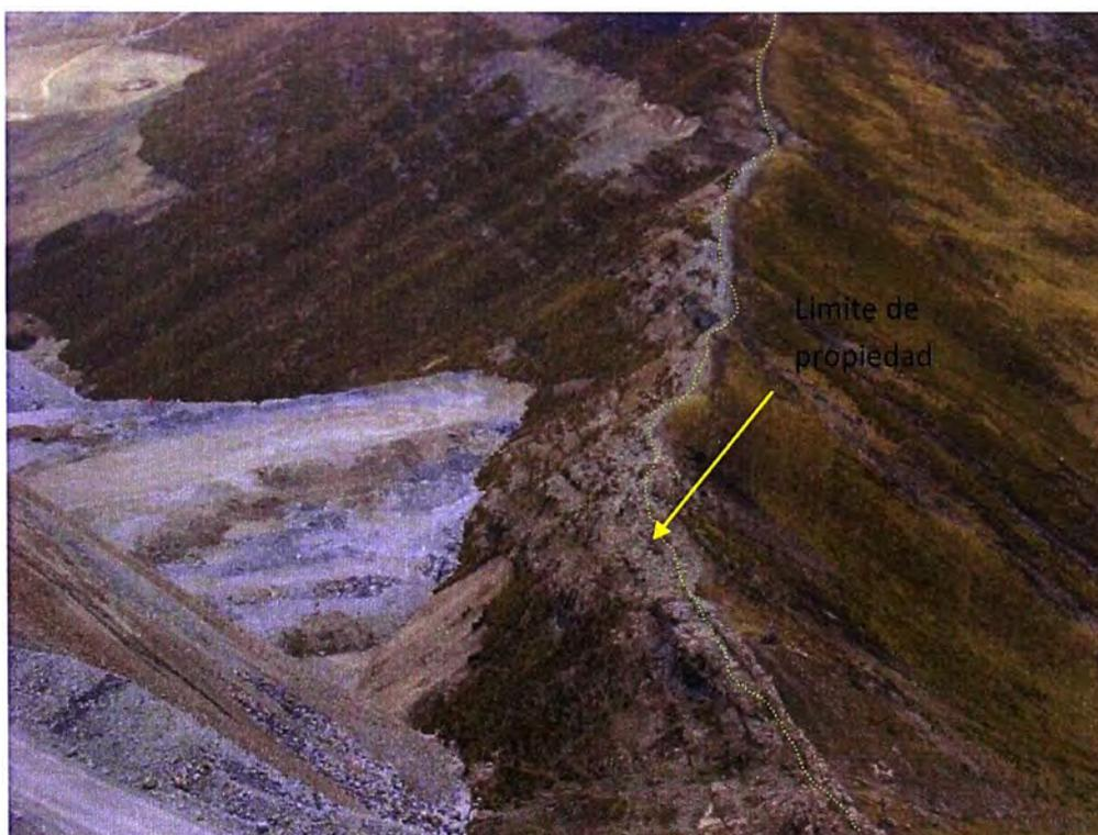
3. Obsérvese la pendiente del terreno y el tamaño requerido de relleno es grande, geotécnicamente es una solución viable a través del relleno estructural.
