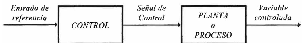
**Fig. 1.5. Diagrama de bloques de un sistema en lazo abierto**
