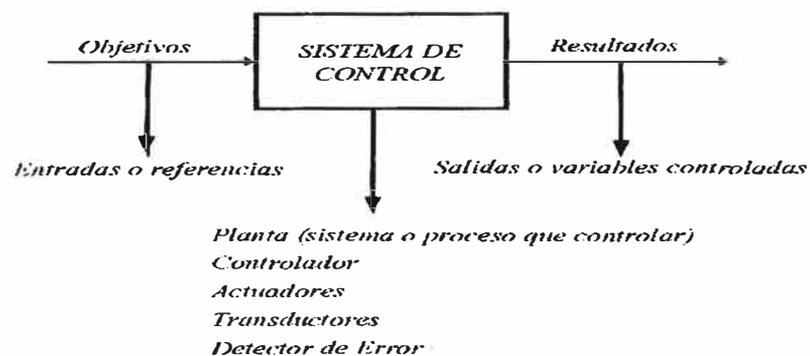
**Fig. 1.1. Diagrama de un sistema de control**
