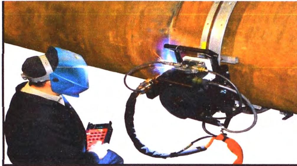
Figura 4.1 –Equipo para soldeo de tuberías
