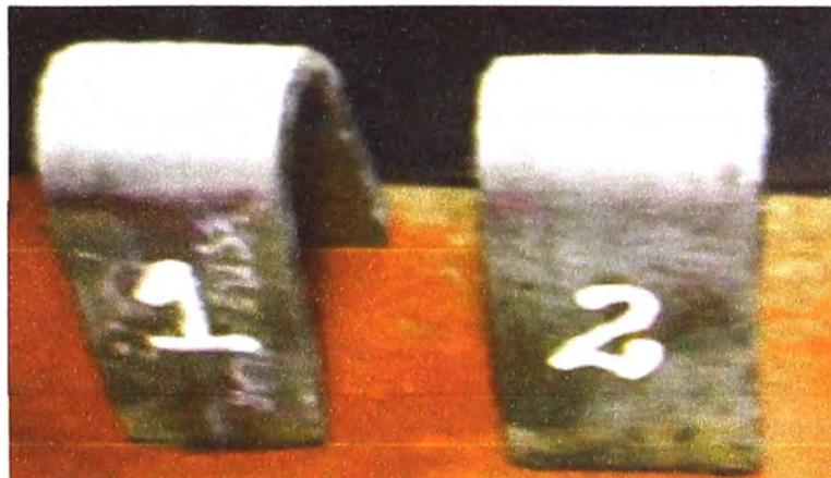
Figura 7.2- Especímenes de ensayo de Doblez
