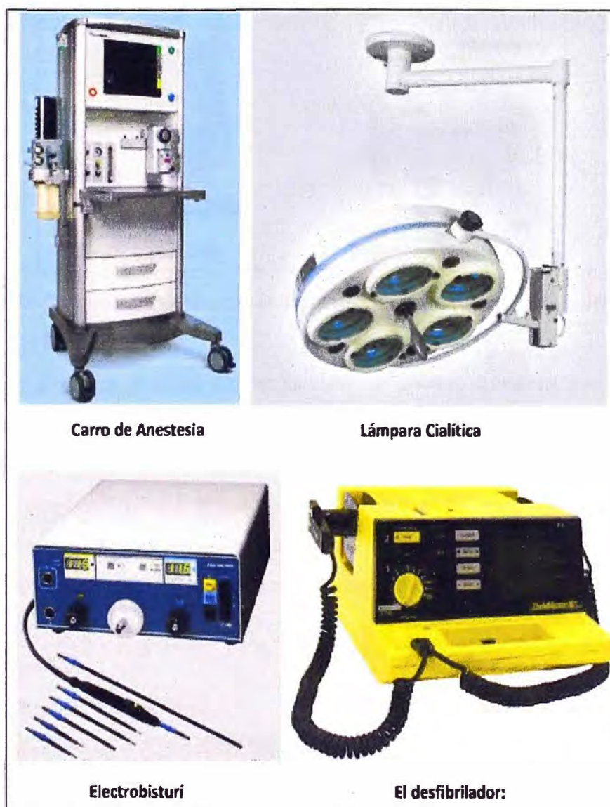
Figura 1.9: Equipos electro – médicos críticos de una Sala de Operaciones.
